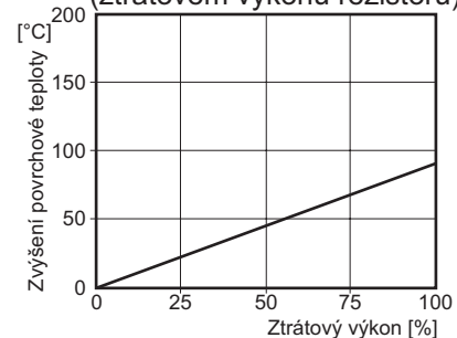
Závislost oteplení povrchu rezistoru na zatížení (ztrátovém výkonu rezistoru)
